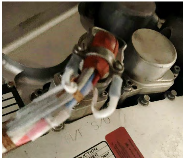
Graphique 10 – Câbles installés sur moteur GE90 – câbles courbés pouvant entraîner une dégradation et un comportement intermittent
