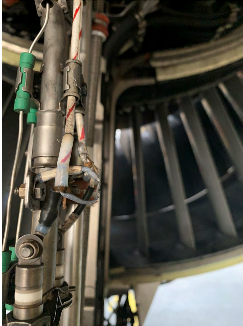
Graphique 9 – Câbles installés sur moteur GE90 – câbles courbés pouvant entraîner une dégradation et un comportement intermittent
